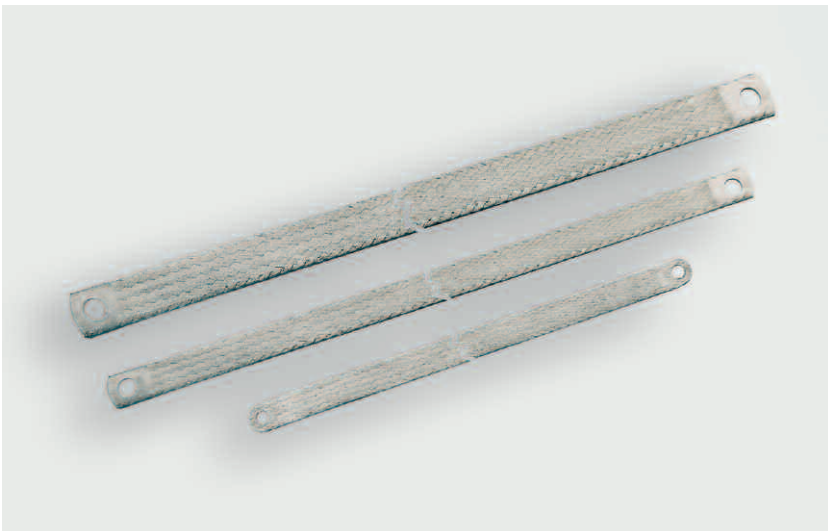
Flachbänder Kupfergeflecht verzinkt, in verschiedenen Längen und Querschnitten. Flachbänder wirken dem Stromverdrängungseffekt bei hohen Frequenzen entgegen und bieten gleichzeitig hochflexible Anschluß- möglichkeiten.
